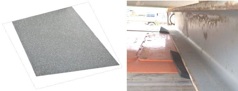
Kitkamatto valitaan sen valmistajan ilmoittaman kuormituskestävyyden perusteella (esim. 290 tonnia/m 2 ) huomioiden kuorman paino ja sen kosketuspinta-ala kitkamaton.
