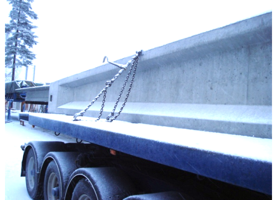
Kuva 3. Poikittaissuuntainen vinosidonta kuormassa olevista sidontapisteistä kohtisuoraan kuormaa kohden sivuille liukumisen ja kaatumisen estämiseksi. Sidontavälineet sijoitetaan symmetrisesti kappaleen painopisteen ympärille samassa pystysuuntaisessa sidontakulmassa. Mikäli kuvan mukaisessa sidonnassa sidontakulma on yli 60°, käytetään sidontatarpeen määrittämiseksi ylisidonnalle laskettuja taulukkoja (Taulukko 1 - Taulukko 3).
